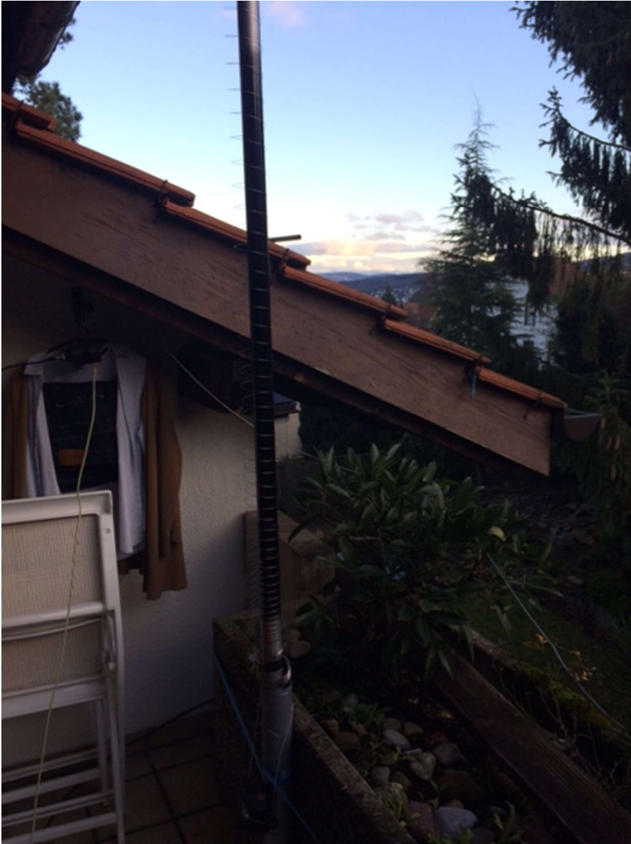
Abbildung 3 Helical 80m in das Montagerohr auf dem Balkon gesteckt
