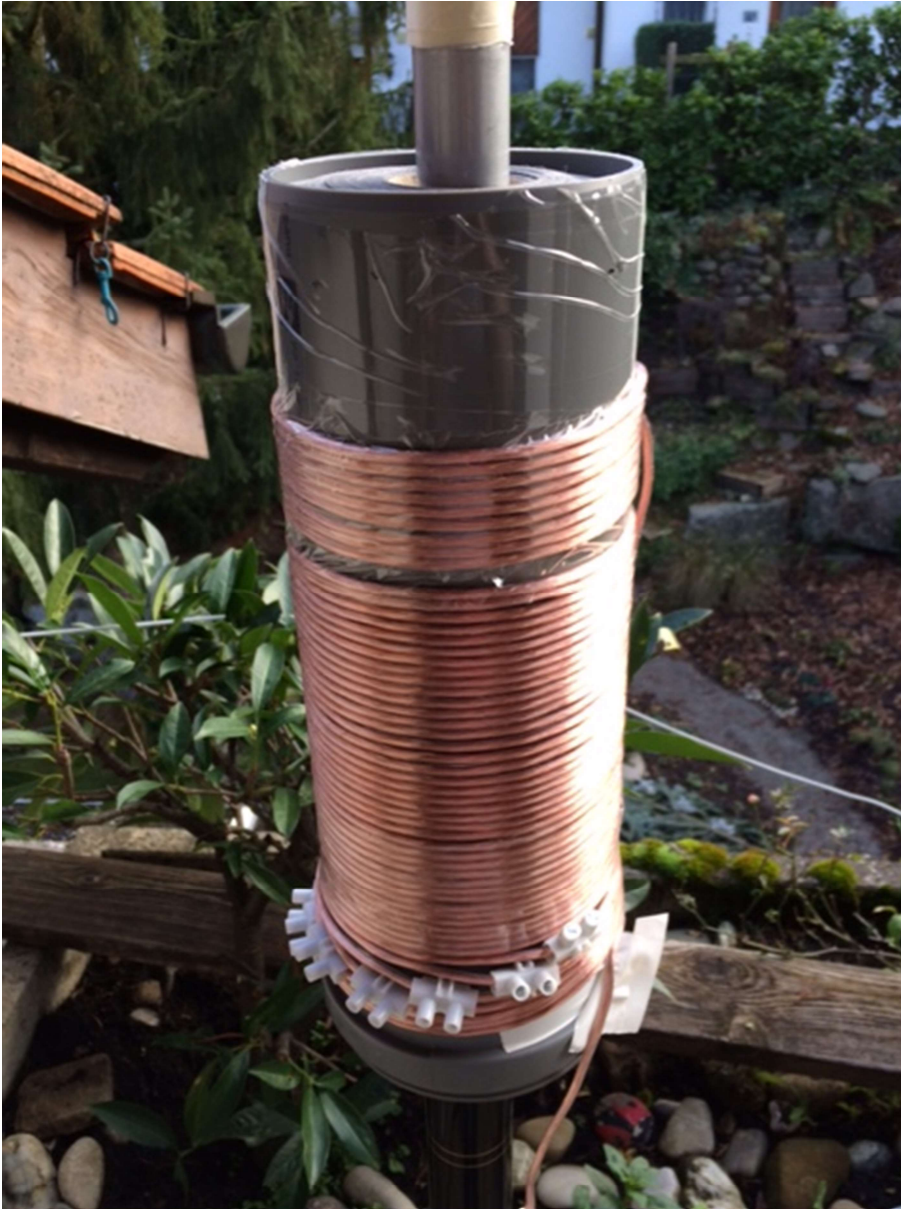
Abbildung 12 Spule mit Kupferlitze 2.5 mm 2 gewickelt
